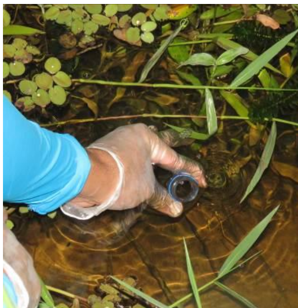
Amostragem da fauna bentônica com a coleta de sedimento de fundo dos sistemas aquáticos.
