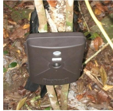
Figura 13 - Armadilha fotográfica (Câmera trap) utilizada para registro de mamíferos de médio e grande porte.
