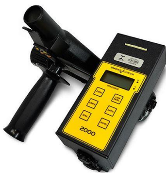
Figura 28 – Modelo do aparelho opacímetro utilizado no monitoramento da fumaça preta na área da Mina Santa Rita.
